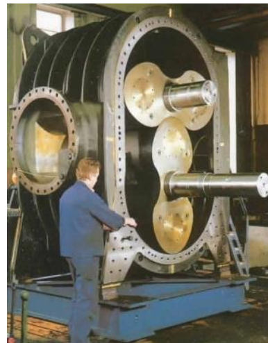
Abbildung 2 Funktionsprinzip der Wälzkolbenpumpe (links), Industrielle Wälzkolbenpumpe (rechts) [www.vacuum-guide.com]
